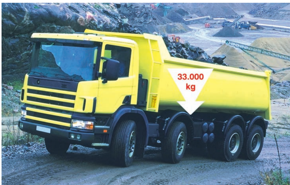
Σχ. 1.17 Μέγιστο επιτρεπόμενο βάρος τετραξονικού φορτηγού.
